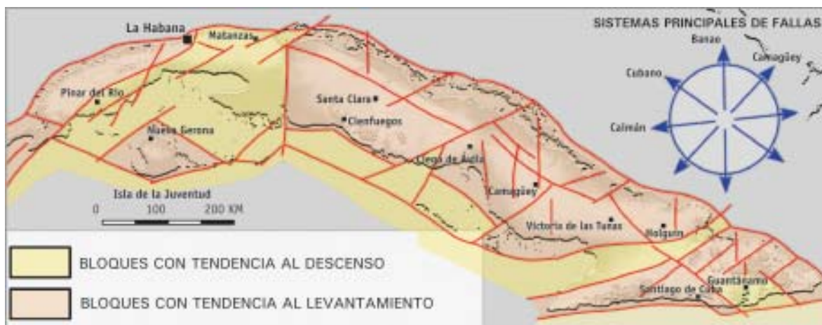
Fig. 2.11: Estructura del territorio cubano dividido en grandes bloques elevados ( horst ) o deprimidos ( grabens ), limitados por sistemas de fallas profundas.
