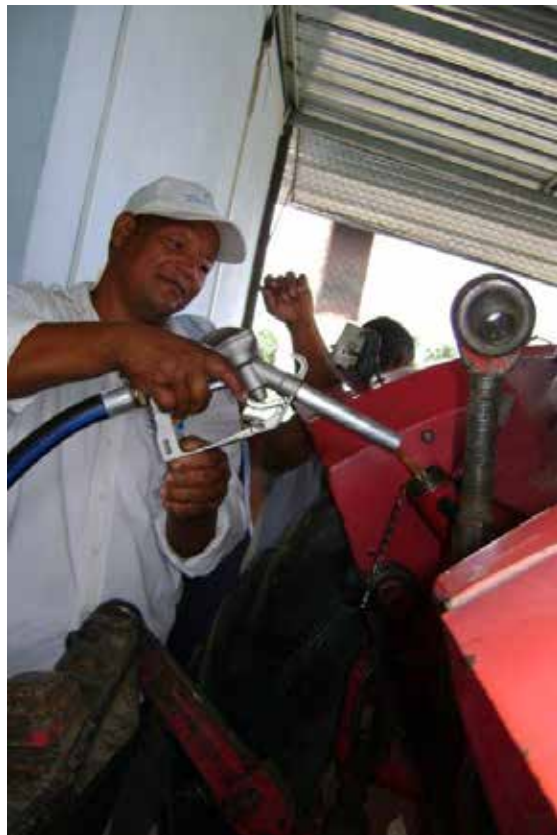
Tractor serviciado con biodiesel de Jatropha curcas
